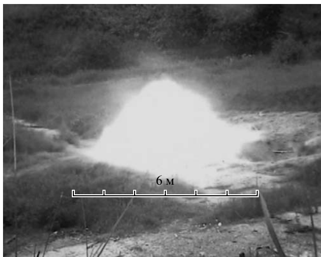
Рис. 8. Видеокадр полигонного взрыва заряда смеси 26% Al + 52% ПХА + 12% НМ + 10% Г массой 1.42 кг.
