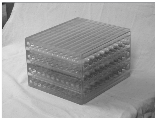
Внутренняя часть многоэлементного ХФЛ типа «световой котел»
