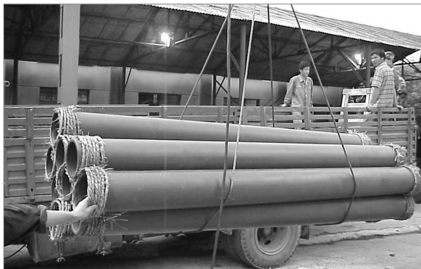
Промышленное СВС-производство в Китае труб для транспортировки абразивных материалов и агрессивных сред
