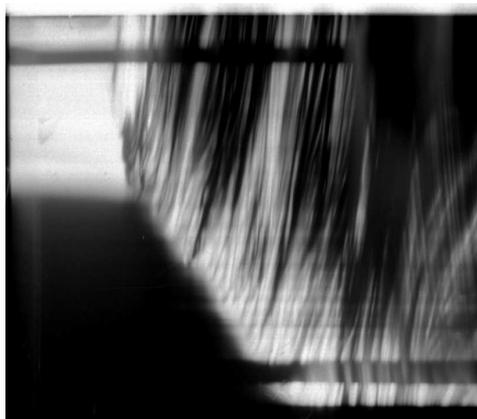
Пример возбуждения конвективного горения (пороговое давление 27 МПа, средняя скорость около 30 м/с) в бомбе с дожигательной секцией в заряде топлива НТБС (диаметр заряда 10 мм, длина 120 мм). Время слева направо, расстояние сверху вниз
